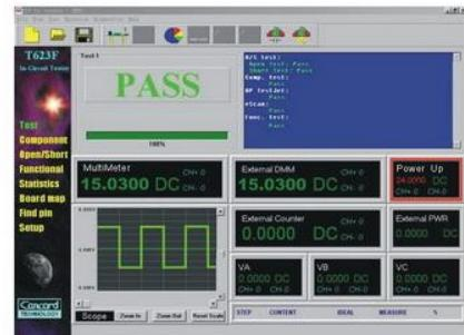
提供電源作功能測試，更可連接外置訊號源、儀器、示波器作關鍵的履行測試。
