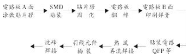
图 1 双面混装 PCB 生产工艺流程 产工艺流程（图 1）
